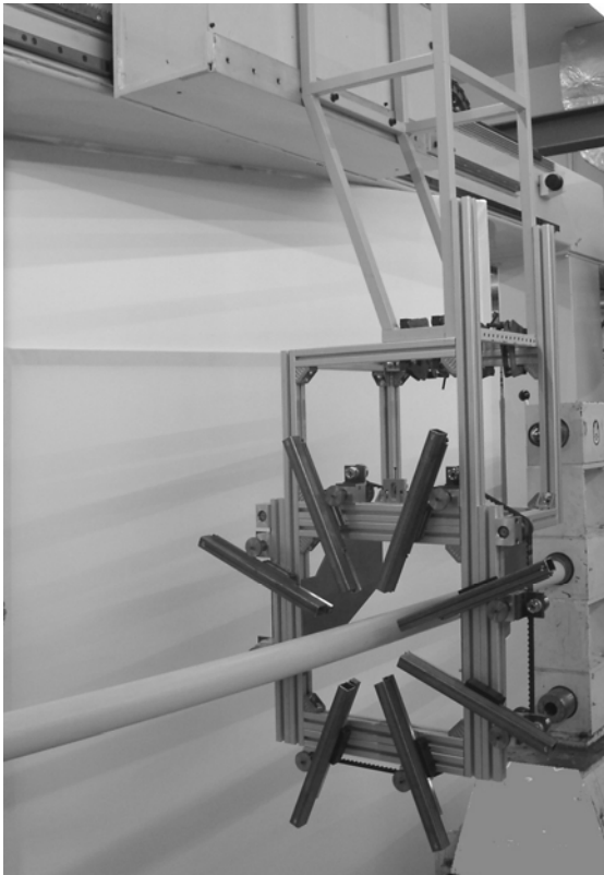
Bild 4: Mechanik einer Wickelanlage mit 8 Fadenablegern
